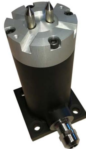
Die Messspitzen Durchmesser 7,0 mm sind durch Federn vorgespannt und werden durch den hydraulischen oder pneumatischen Vorhub mit einer Federkraft von ca. 28 N gegen die zu messende Oberfläche gedrückt. Erst bei Berührung beider Messspitzen mit der leitenden Metalloberfläche liegt der Messwert unmittelbar vor. Der Federweg der Messspitzen kann bis zu 20 mm betragen.
